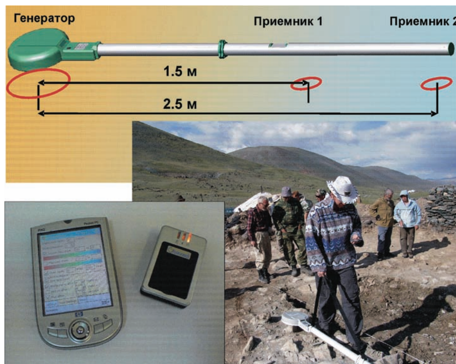
Рис. 1. Аппаратурно-программный комплекс ЭМС: схема прибора, управляющая программа на КПК и беспроводной GPS приемник, пример полевых работ
